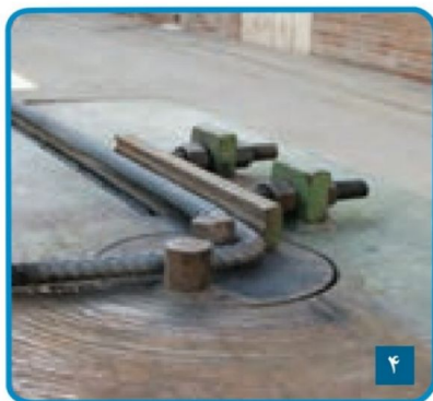
شکل ۳-۶۴ خم کردن میلگرد
