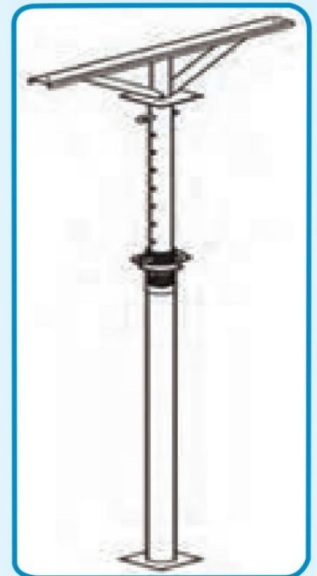
شکل ۳-۲۲- شمع فلزی کامل تنظیم ارتفاع
