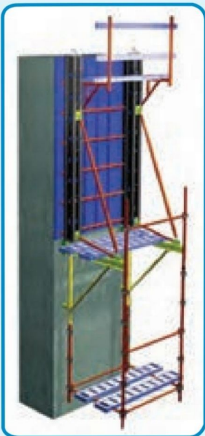
شکل ۲۰-۳- قالب رونده (لغزنده)
