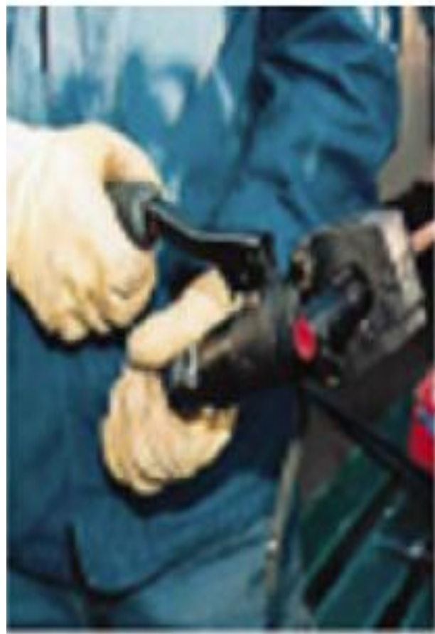
(۲) نحوه استفاده از پرس کابلشو
